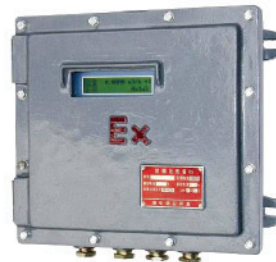
防爆型 HX-LBSG3 防爆等级 DII BT4，用于防爆场合 尺寸：285×265×90mm
